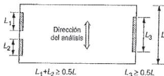
Figura 3.7 Requisito sobre muros de carga perimetrales paralelos
